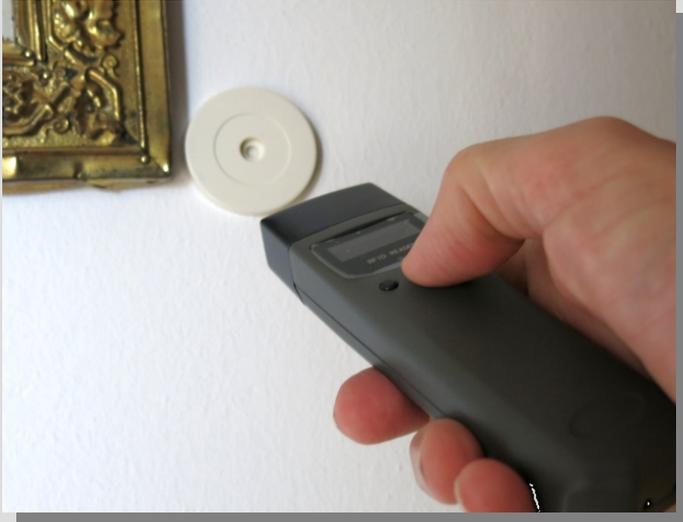
ZE.guard dient in Verbindung mit dem mobilen Lesegerät TX-mobile der Protokollierung von Kontrollpunkten während des Wächter-Kontrollgangs. Dabei sind die Kontrollpunkte in der Software vordefiniert, und der Wächter kann eine Liste mit den Kontrollpunkten abgehen. Zu jeder Kontrollbuchung werden Zeit, Wächter und Kontrollpunkt gespeichert. Mit ZE.guard können diese Buchungen sortiert nach Kunde, Objekt, Kontrollpunkt und Zeit als PDF ausgegeben werden.
